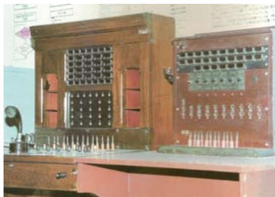
圖 7-4-4 早期使用的小型人工長途電話交換機（摘自徐耀南、洪兆鉞《臺北電信史略》）
